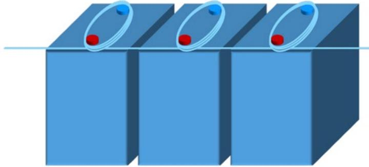
如电池组侧面紧贴，光缆也可绕成环并铺设与电池侧面，并用电工胶布固定。
