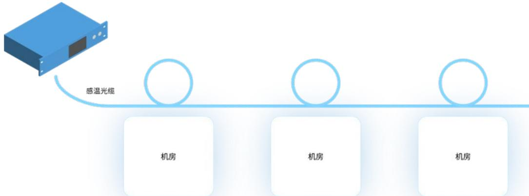
系统提高分布式光纤温度监测分区管理界面，用户可在系统管理光缆分区，当主机感知温度超过阈值时，对应的区域会对应改变并告警。同时，系统也支持温度突变告警。
