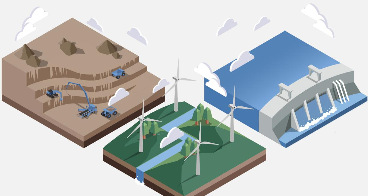
系统不仅能实现对基坑、露天矿等工程结构及大坝等大型混凝土建筑的精准安全监测，确保安全与效益，预防重大事故，还能实时监测风机塔筒倾斜、叶片振动等数据，保障运行安全。
