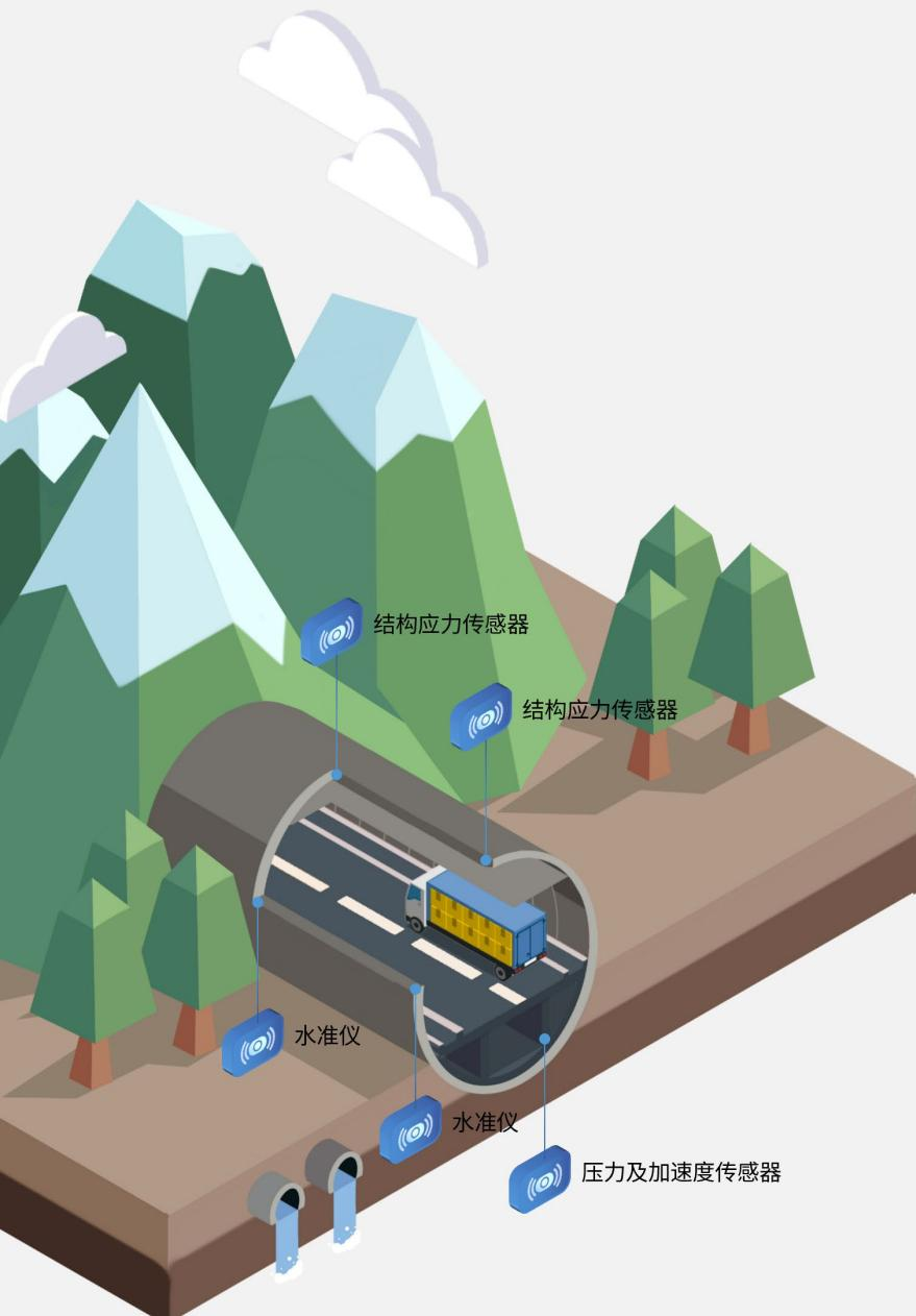
系统致力于为管理人员提供轴力、渗水、土压力等实时数据及精准的隧道结构性病害信息，从而确保隧道的长期稳定性与安全性。
