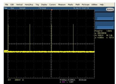
脉宽测试图 (脉宽 10ns、200ns, 重频 1KHz)
